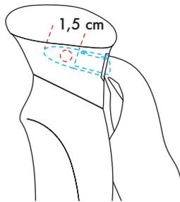
**6** Infilare il perno nel foro più largo sul lato della manopola e spingerlo fino a fine corsa.
