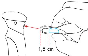
**5** L'asola infilata deve lasciare il foro libero per il passaggio del perno.
